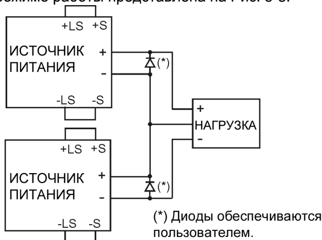
Рис.5-3: Последовательное соединение для получения положительного/отрицательного выходного напряжения
